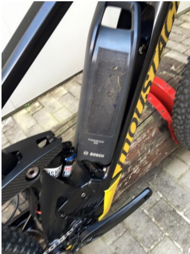
La fase di rimozione della batteria. Foto Pro-M
